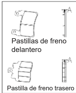
Figura 27 Inspección de las pastillas de freno
