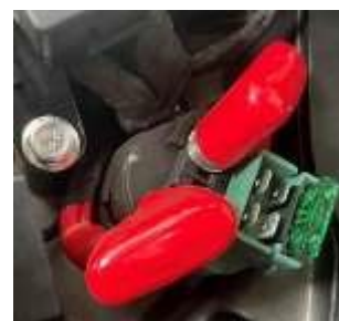
Figura 35 Fusible principal del relé de arranque
