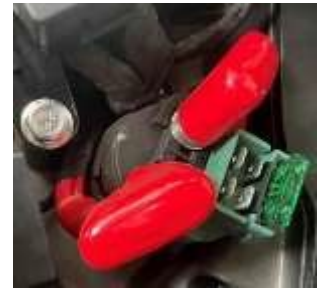
Figura 35 Fusible principal del relé de arranque
