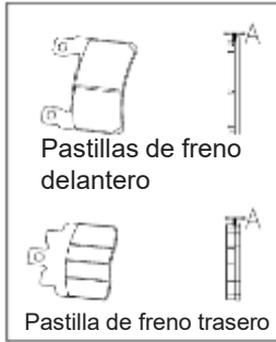
Figura 27 Inspección de las pastillas de freno
