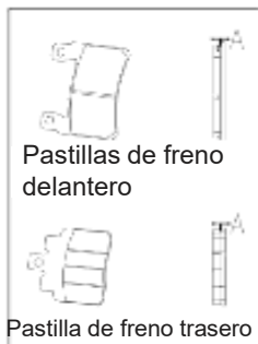
Figura 31 Inspección de las pastillas de freno
