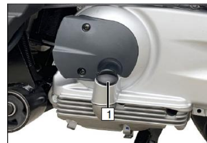
1. Tampão do reservatório
