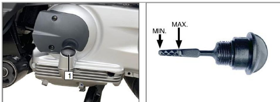
1. Tampão do reservatório
