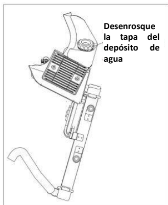
Figura 33 Adición de refrigerante
