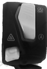
Grupo interruptores derechos
