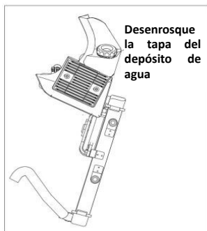
Figura 33 Adición de refrigerante
