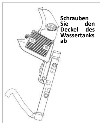
Abbildung 33 Einfüllen von Kühlflüssigkeit
