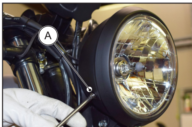
A. Viti fissaggio del gruppo faro
