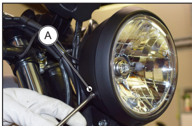
A. Tornillos fijación del grupo faro
