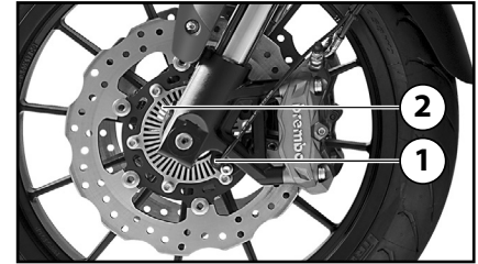
1. Sensor in het voorwiel 2. Rotor van het voorwiel
